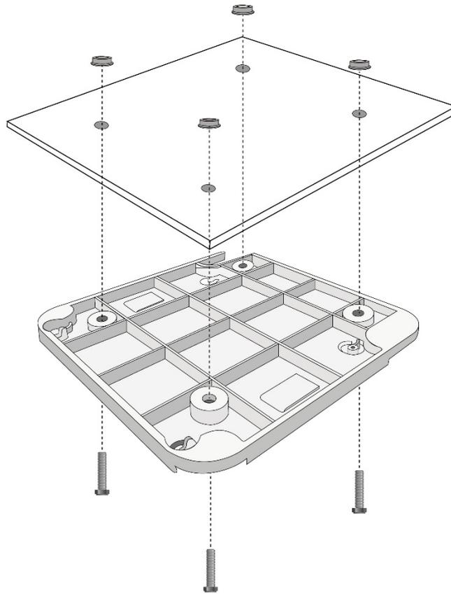
图 3-8 吸顶支架安装示意图
