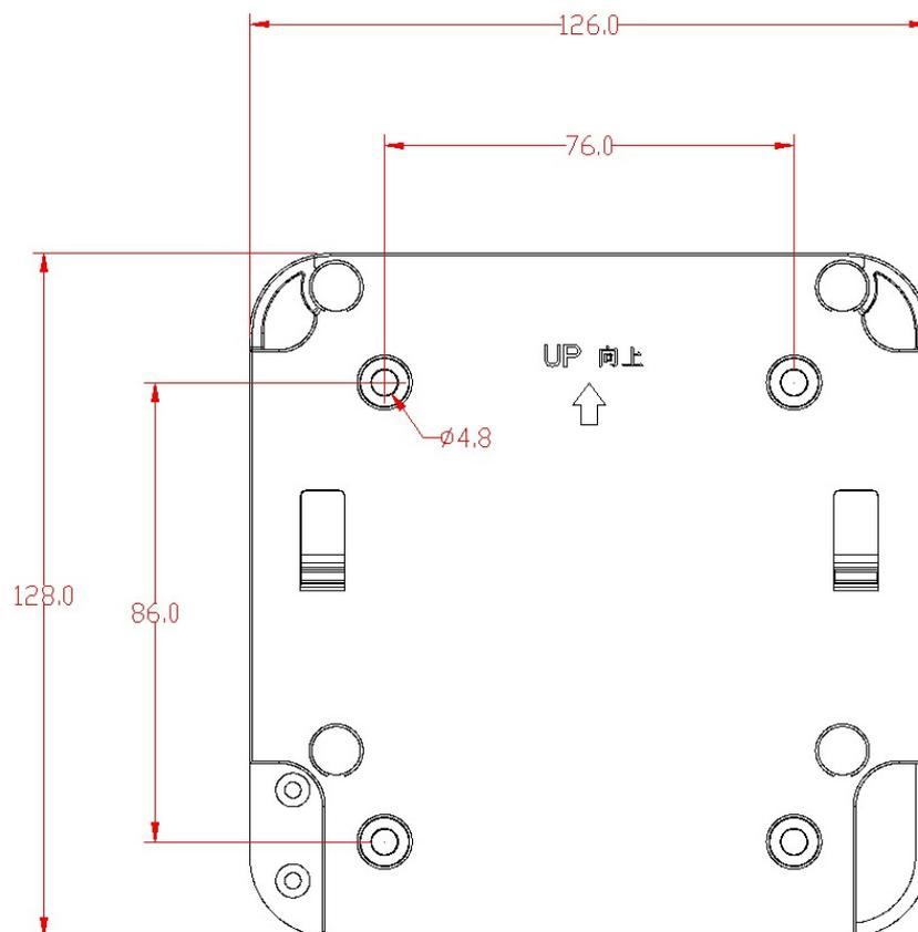
图 3-1 AP-MountKit-T1 支架尺寸图（单位 mm）
