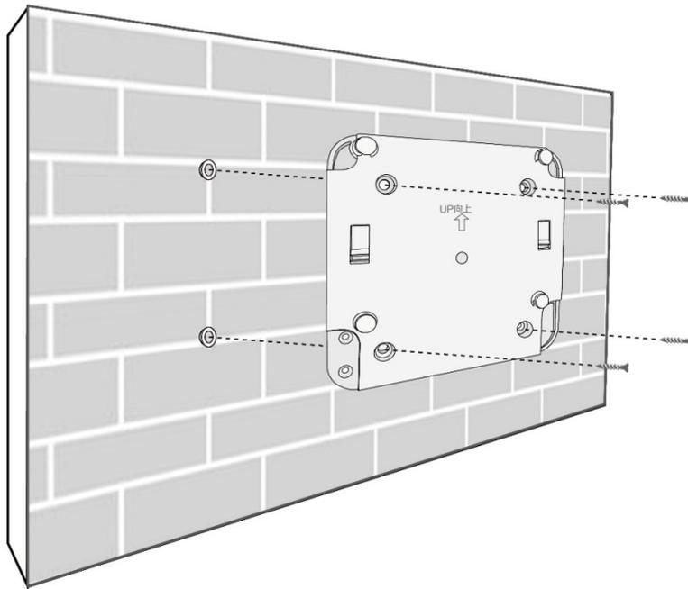
图 3-5 壁挂支架安装示意图
