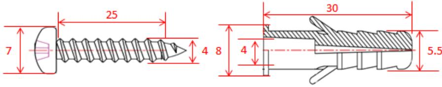
图 3-2 AP-MountKit-T1 壁挂安装螺丝尺寸图（单位 mm）
