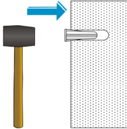
图 3-4 固定膨胀螺管示意图
