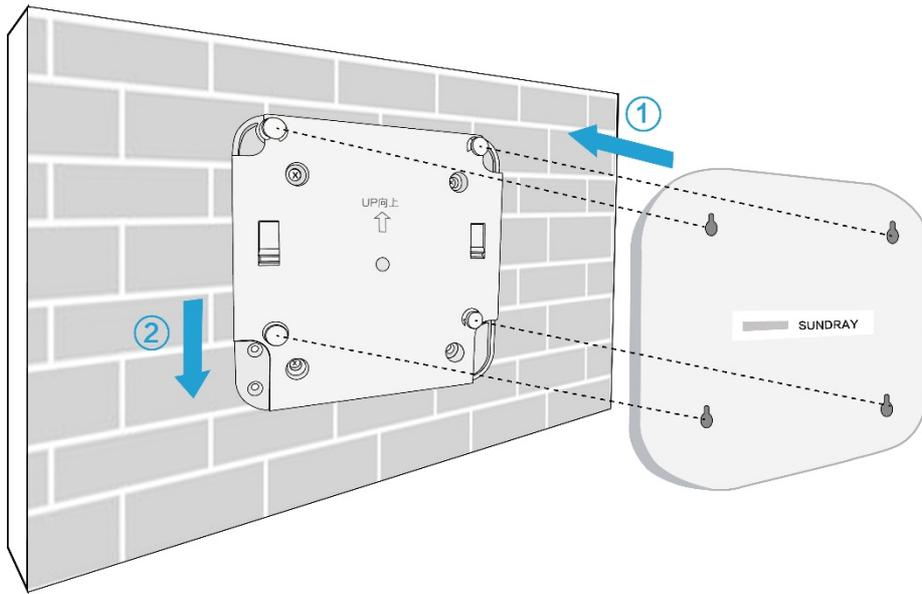
图 3-6 AP 安装到壁挂支架示意图
